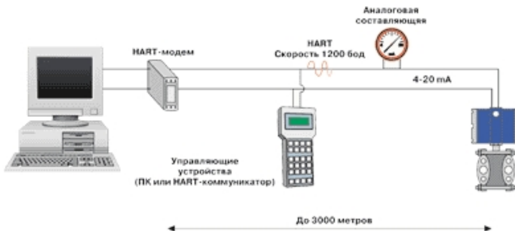
Рис.2 Режим передачи цифровой информации одновременно с аналоговым сигналом
